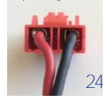
Posizione cablaggi su connettore / Cable positioning in the connector
